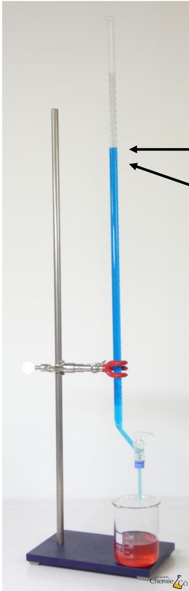
Weiterhin ist darauf zu achten, dass sich die Augenhöhe beim Ablesen stets auf Höhe des Flüssigkeitsstandes befindet, um ein waagerechtes Ablesen zu gewährleisten.
