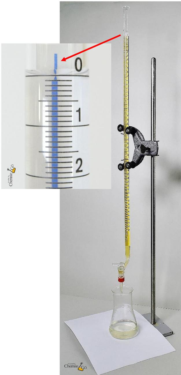
Um eine Bürette mit der Maßlösung zu befüllen muss zunächst der Hahn geschlossen werden.
