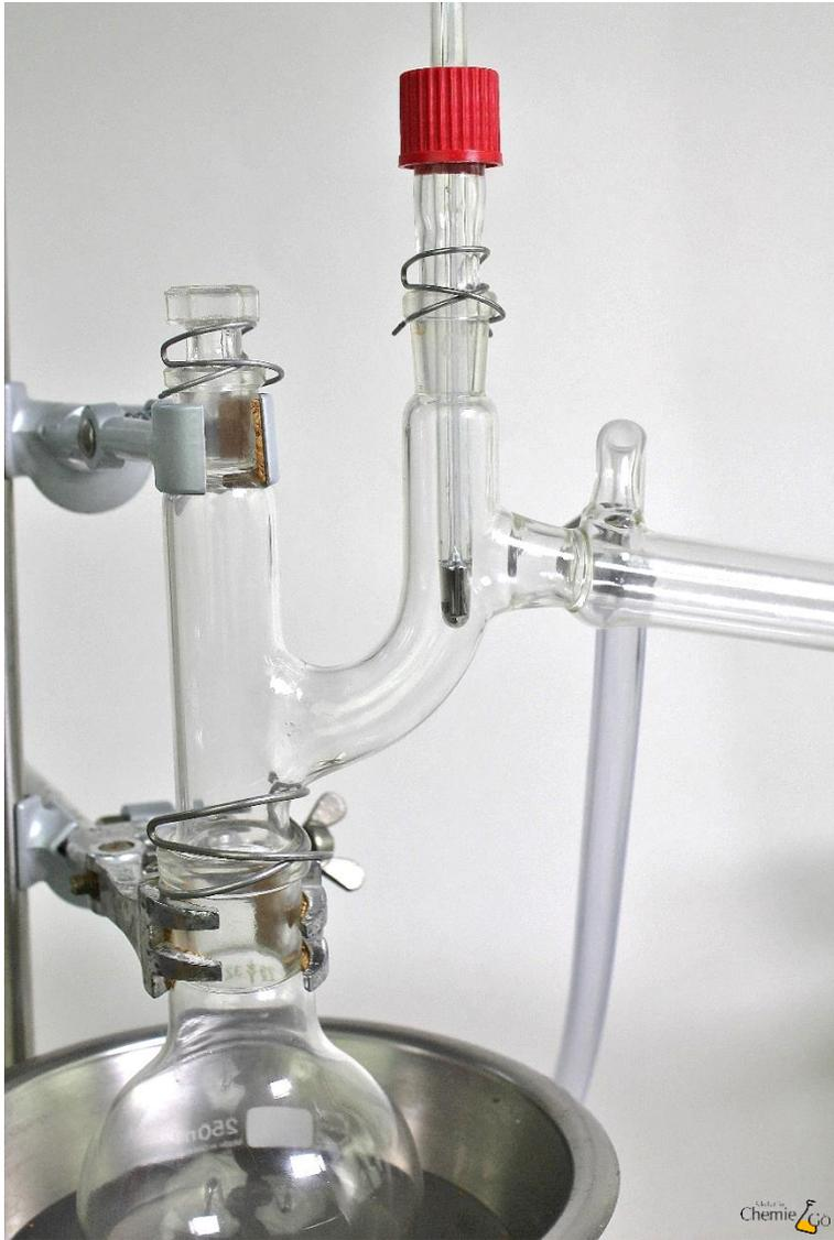
Der Claisen-Aufsatz dient als Verbindung zwischen Probengefäß und Liebigkühler.
