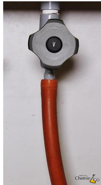
Gummischläuche können z.B. als Verbindung zwischen Gasanschluss und Gasbrenner verwendet werden.
