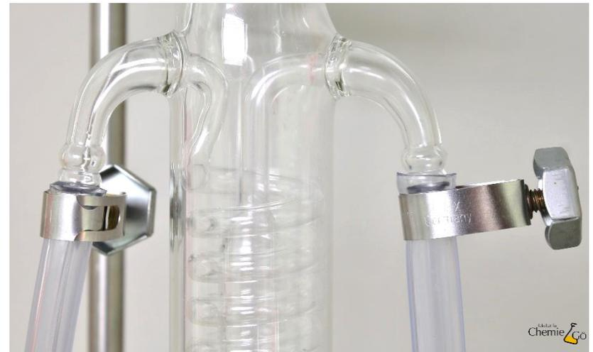
Gewebeschlauche werden bei Apparaturen verwendet, bei denen ein berdruck entsteht.
