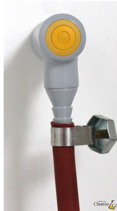
PVC-Schläuche werden zum Weiterleiten von Gasen oder Flüssigkeiten verwendet.
