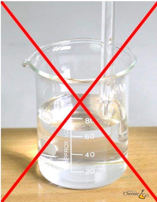
Beim Filtrieren ist darauf zu achten, dass der Trichterhals nicht in die Lösung eintaucht, da die Filtration durch Aufbau eines Gegendrucks zum Erliegen kommt.
