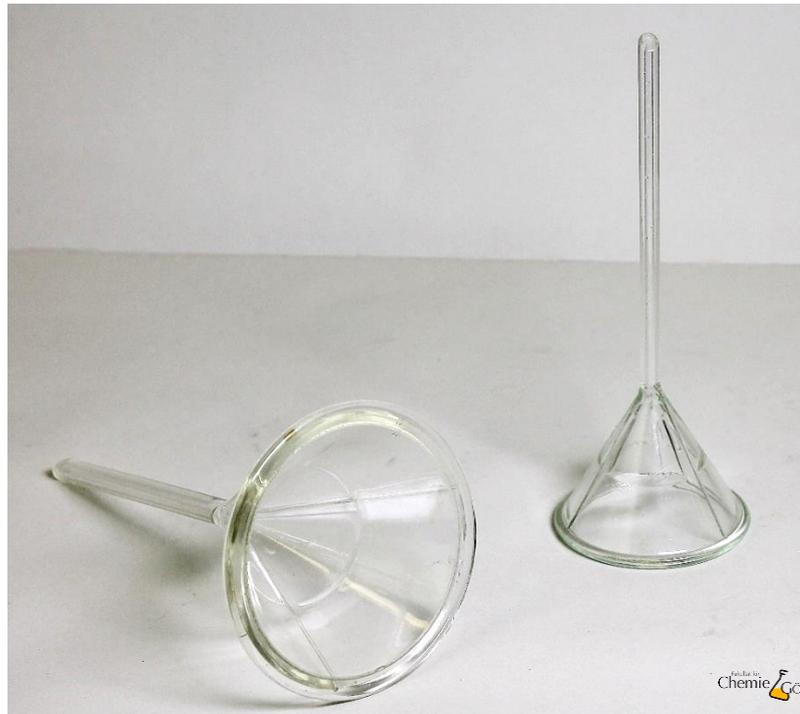
Der Trichter wird in dem Filtriergestell positioniert und ein Auffanggefäß untergestellt.
