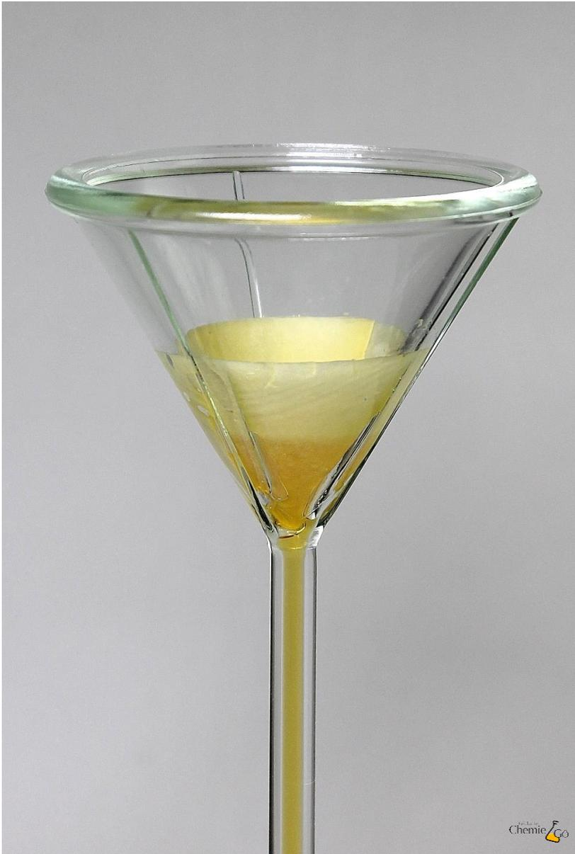
Für einen Schnellauftrichter wird ein Rundfilterpapier benutzt.
