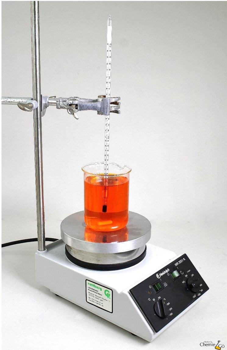
Das analoge Thermometer wird mittels Stativklemme so befestigt, dass es in die Lösung eintaucht.
