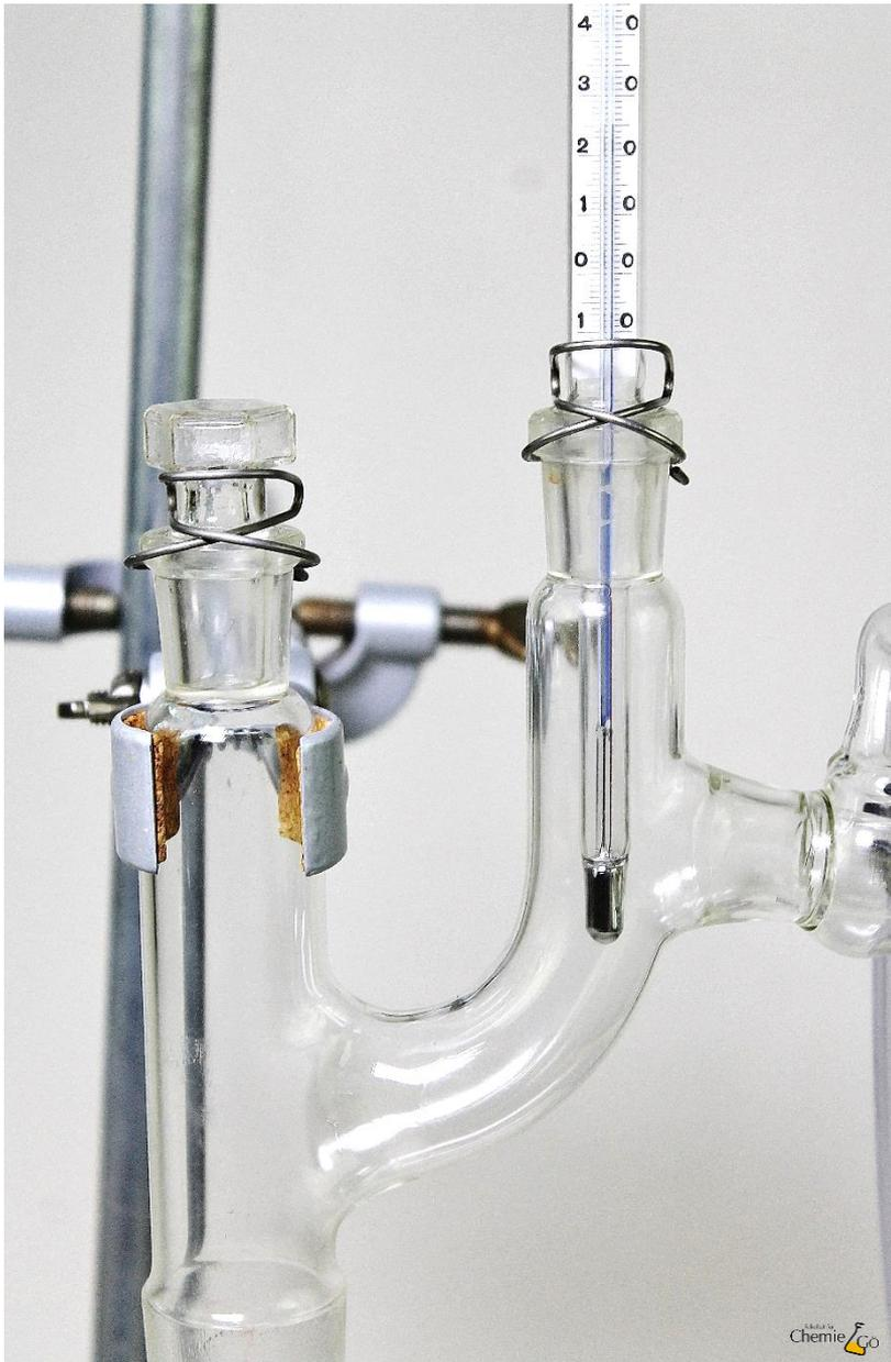
Bei evakuierten Glasapparaturen empfiehlt sich aus Gründen der Dichtheit die Verwendung eines Schliffthermometers.
