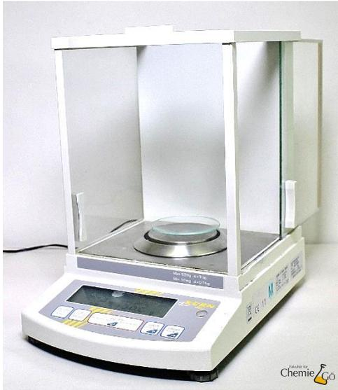
Uhrgläser können unter anderem zum Ein- und Abwiegen kleiner Mengen von Substanzen verwendet werden.
