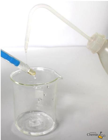
Nach jeder Messung muss die Messzelle mit desmineralisiertem (dem.) Wasser kurz abgespült werden.
