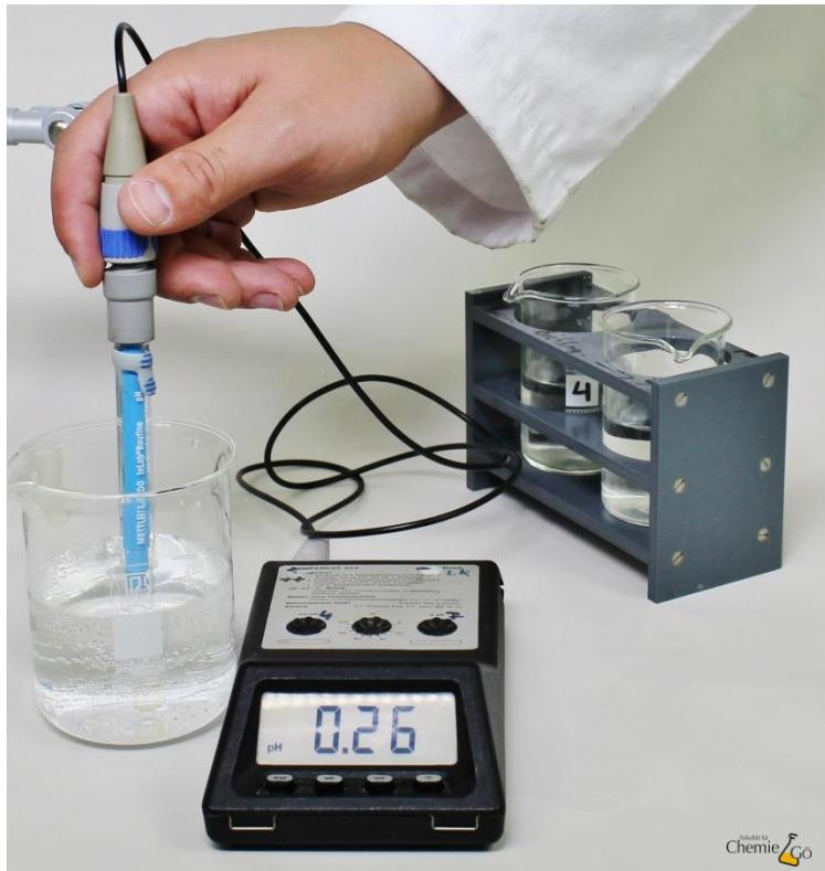
Für eine Messung des pH-Wertes wird die kalibrierte Messzelle in die zu untersuchende Lösung getaucht und der Messwert abgelesen.
